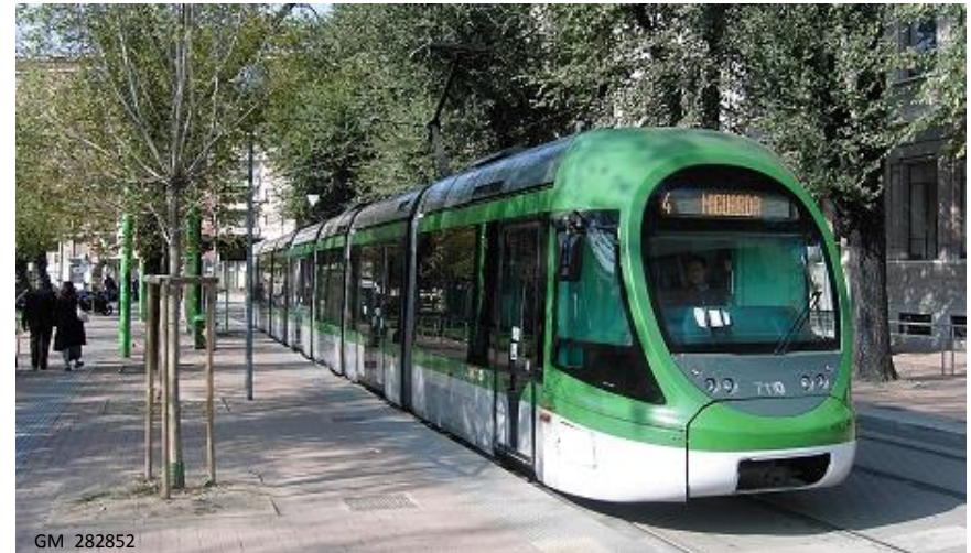
Milano, tram a pianale inter. ribassato, AnsaldoBreda Sirio (1989)
