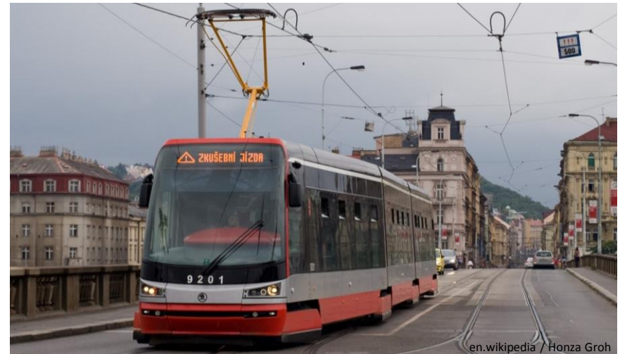
Praga, tram a pianale inter. rib. e carrelli ruotanti, Škoda 15T (2009)
