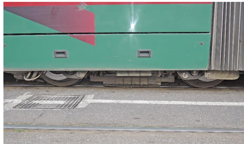
Pattino elettromagnetico. Il pattino, attratto dalla rotaia, aderisce alla sua superficie di rotolamento e consente efficaci frenature di urgenza
